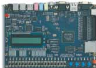
Плата для разработки и обучения Altera DE2
